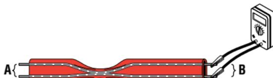
La localización aproximada del cable conductor cortocircuitado, expresada en un porcentaje de la longitud del cable calefactor desde el extremo delantero, es:
